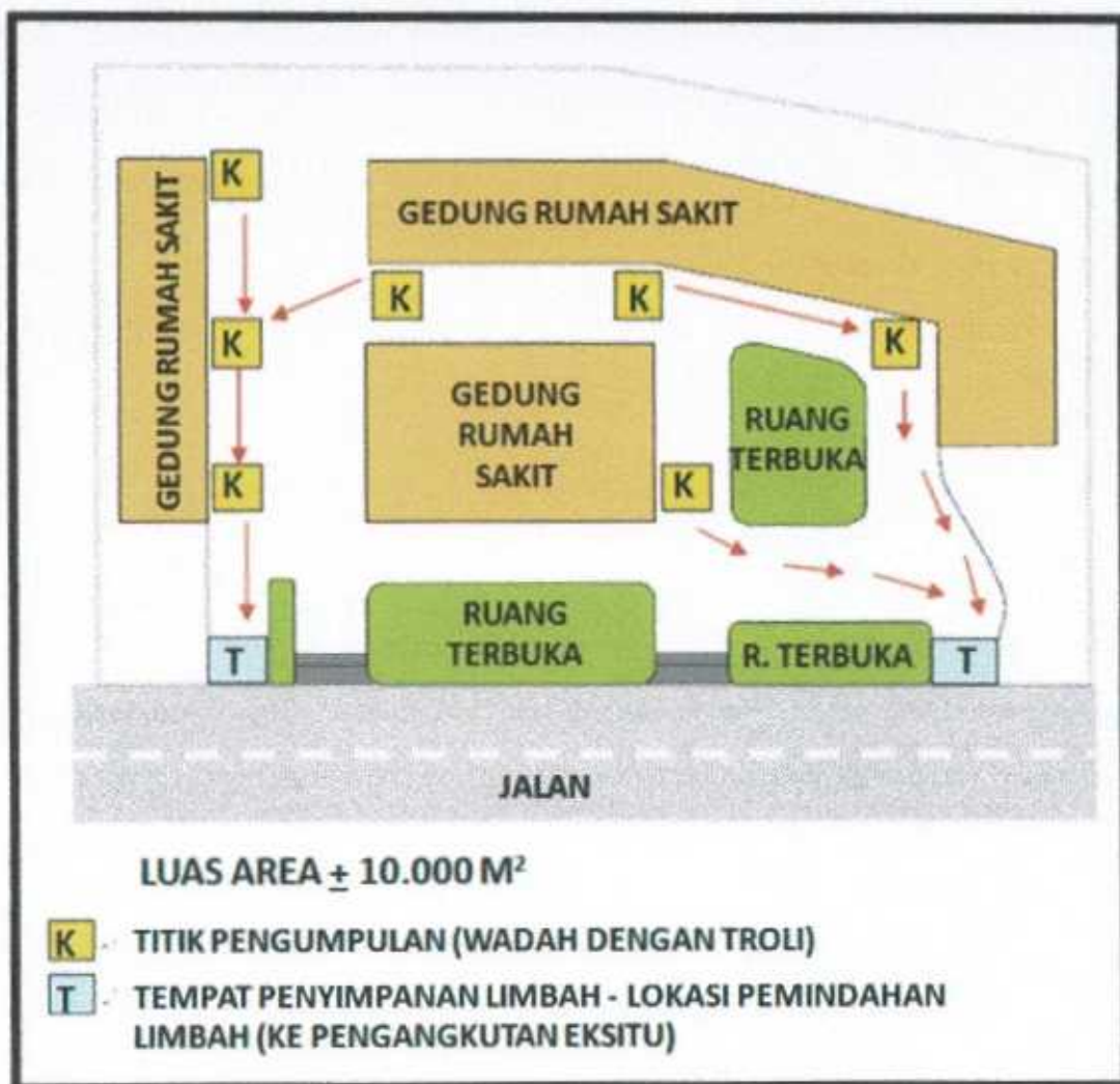
Gambar 13. Contoh tata letak rute sistem pengumpulan limbah dari kegiatan fasilitas pelayanan kesehatan
